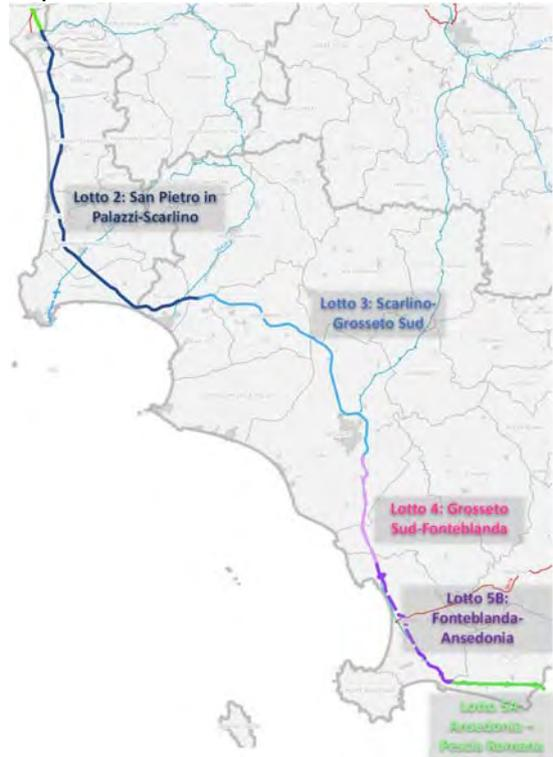
La proposta di revisione del progetto prevede la realizzazione di due carreggiate distinte, l'eliminazione di svincoli a raso e la realizzazione di complanari per ampliamento dell'infrastruttura esistente, rendendo più sicura la circolazione.
