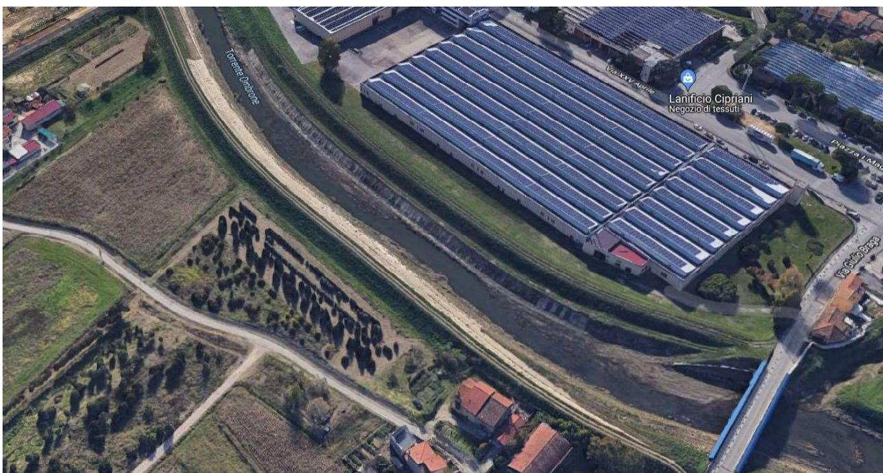
Il tratto è caratterizzato dalla presenza di specchiature in calcestruzzo a protezione della scarpata arginale lato fiume, ormai ammalorate e pertanto da ripristinare.
