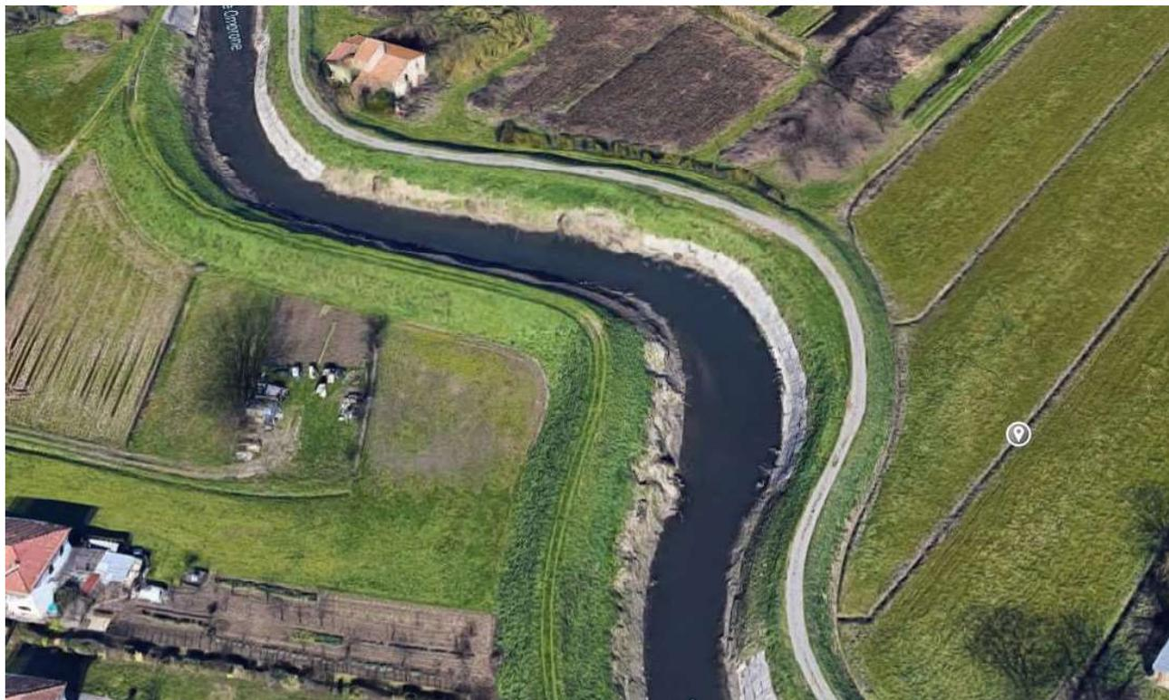
Nel tratto, per un'estensione di circa 200 metri lineari, si rilevano con frequenza locali smottamenti della bassa sponda, causati dall'azione erosiva delle acque di piena, da ripristinare mediante:
