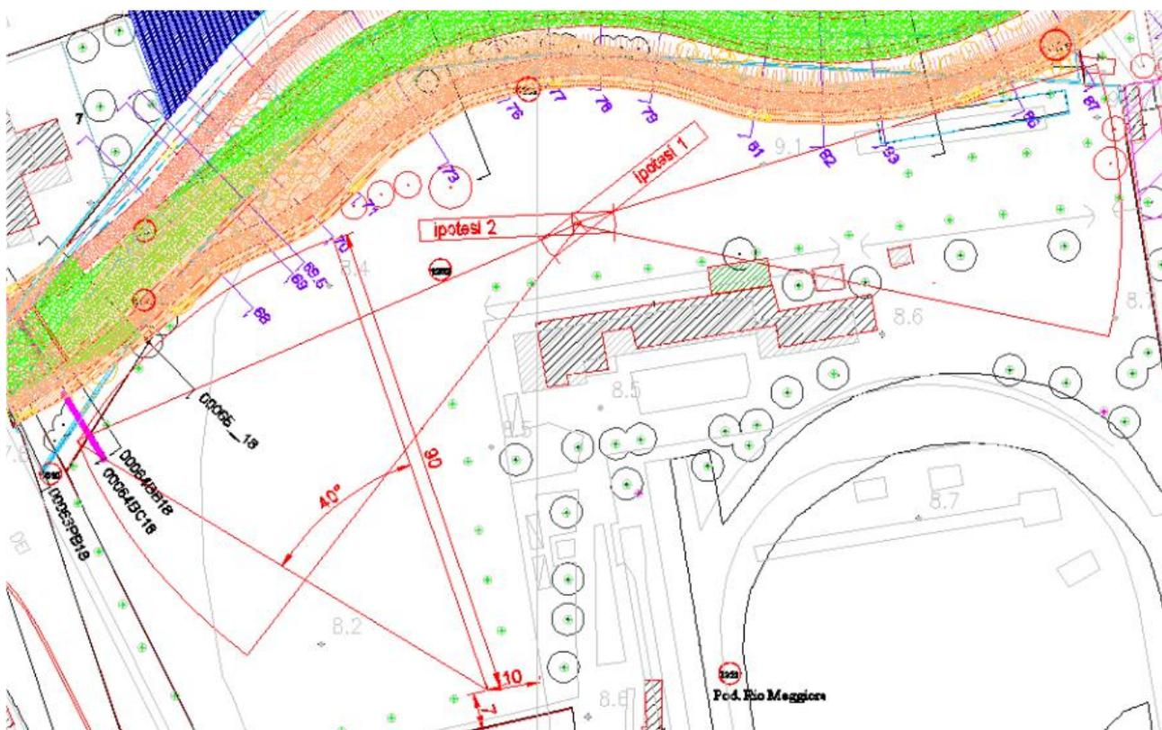
**Figura n. 6** – Planimetria del campo scuola con i volumi che confliggono con la soluzione n.2 del settore del lancio del giavellotto, dove con tratteggio di colore verde è indicato l'ampliamento in progetto degli spogliatoi esistenti
