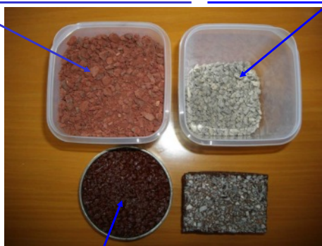
Carota di conglomerato additivato con ossido di ferro
